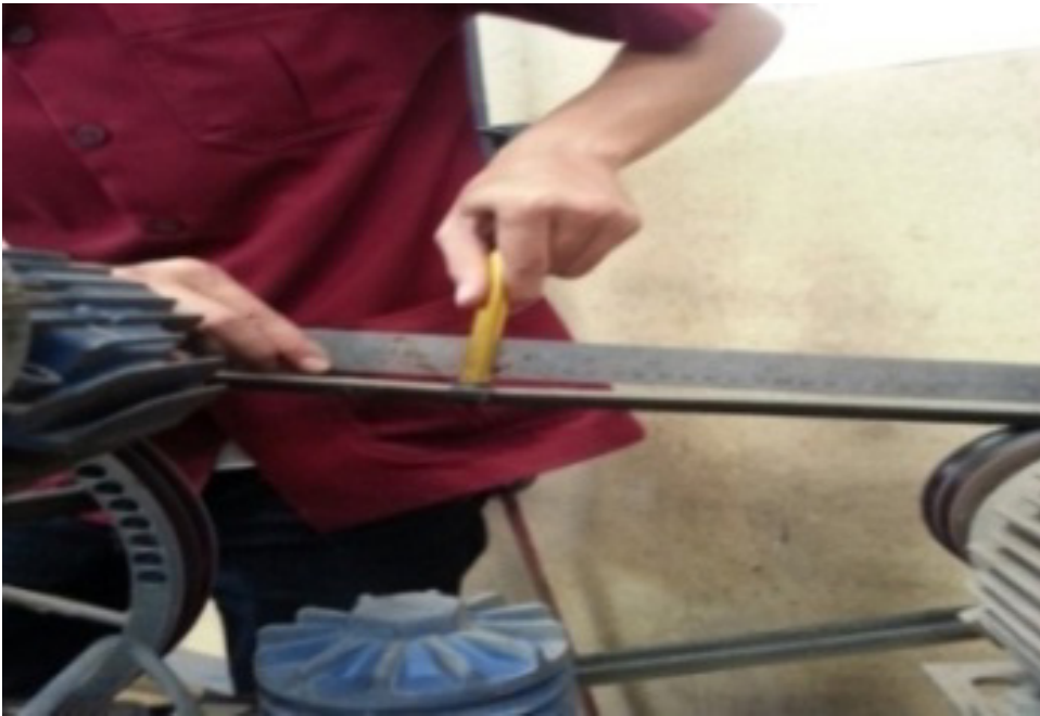
ภาพที่ 4 การวัดระยะความตึงสายพาน ที่มา: ถ่ายภาพโดยผู้เขียน
