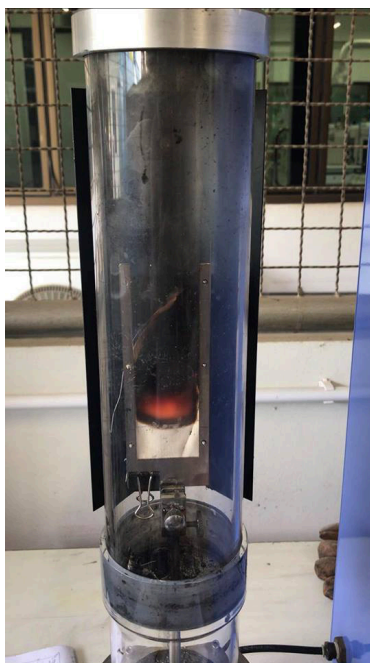
ภาพที่ 4 วิเคราะห์ค่าปริมาณออกซิเจนที่น้อยที่สุดที่ช่วยในการติดไฟ ที่มา: ภาพโดยผู้เขียน
