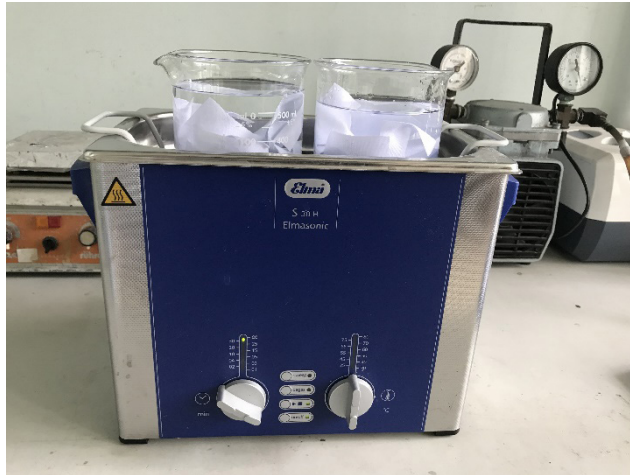
ภาพที่ 3 การเคลือบผ้าโดยกาจุ่มเคลือบในเครื่องล้างความถี่สูง ที่มา: ภาพโดยผู้เขียน
