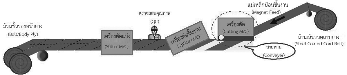
ภาพที่ 4 กระบวนการผลิตชั้นร่องหน้ายาง
